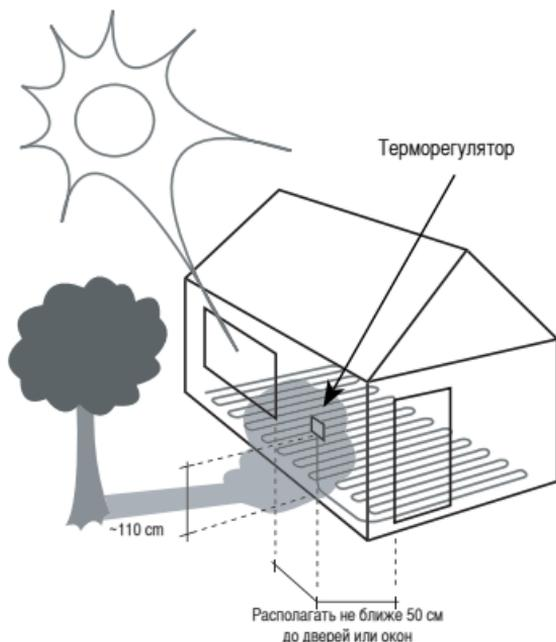
2. Терморегуляторы данной серии имеют плоскую тыльную/заднюю поверхность и могут устанавливаться прямо на стену или на специальную монтажную коробку. При установке прямо на стену нужно помнить, что необходимо смонтировать 7-8 проводов в достаточно малом объеме корпуса регулятора.
